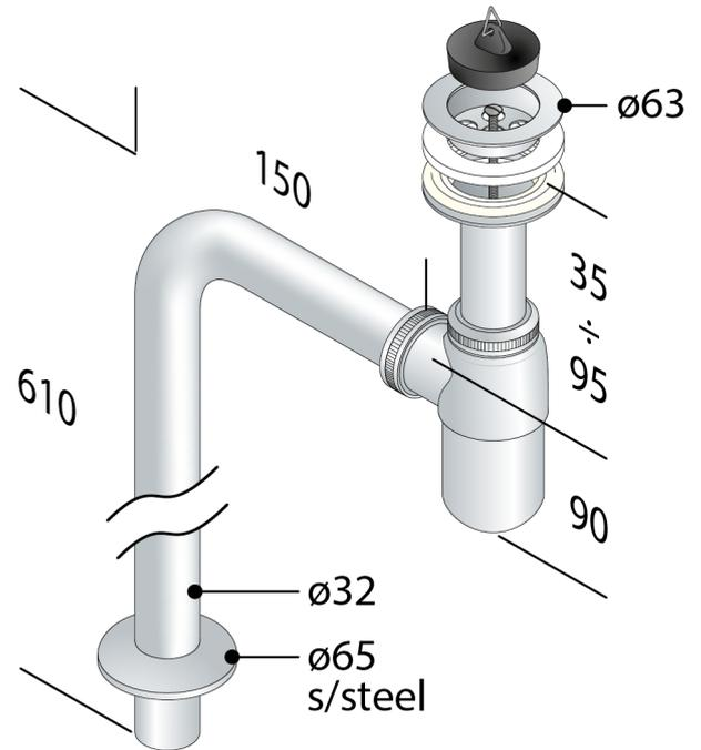
**Abmessungen**  $\varnothing 63 \times \varnothing 32$
