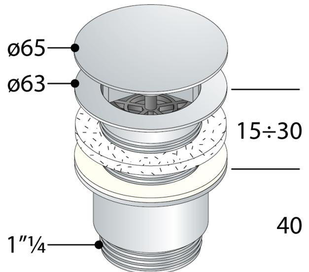
**Abmessungen**  $\varnothing 65 \times 1"1/4$
