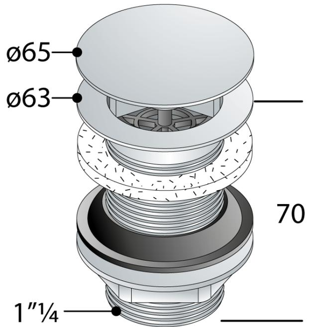
**Abmessungen**  $\varnothing 63 \times 1\frac{1}{4}$
