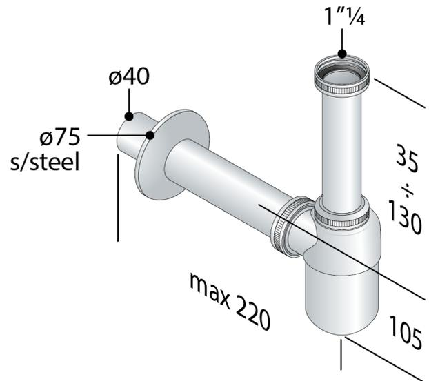
**Abmessungen** 1"1/4  $\times$   $\varnothing 40$
