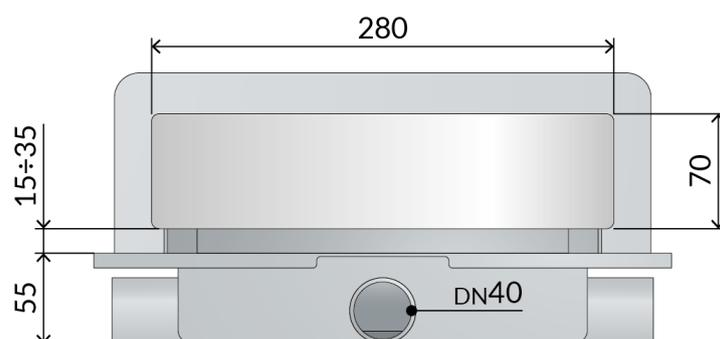
1. coperchio in acciaio inox AISI 316 regolabile per pavimenti di spessore da 10÷30
